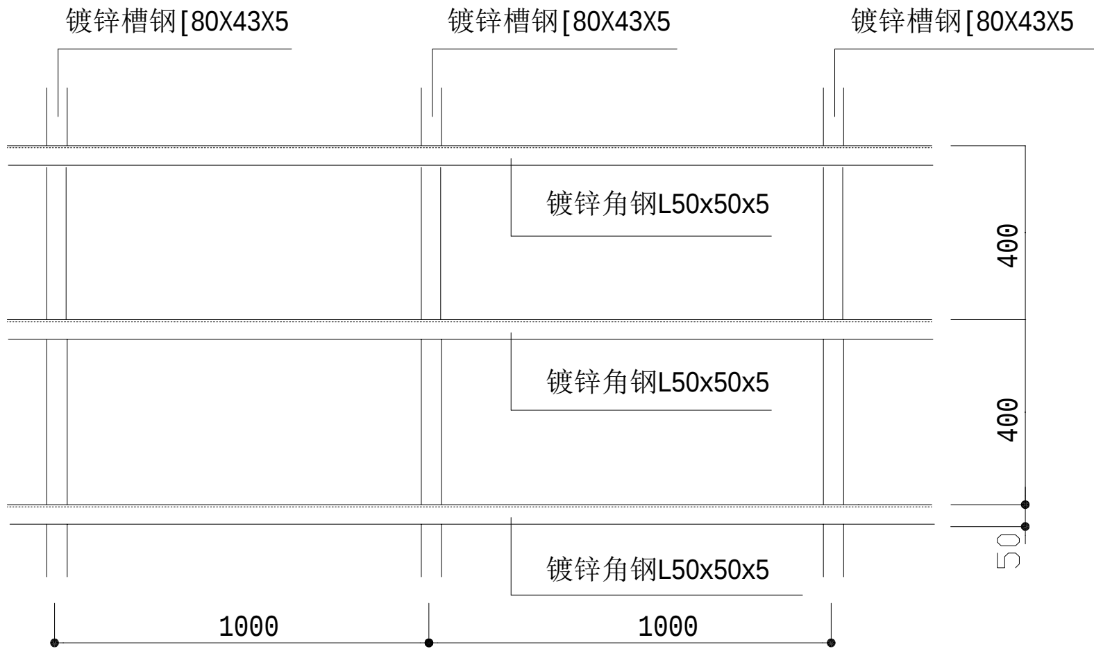
C 干挂立面钢结构骨架布置图 1:20
