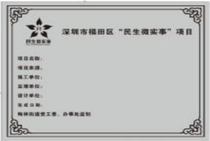
0.4m高×0.6m宽完工牌 2厚不锈钢板 字体及图案蚀印
